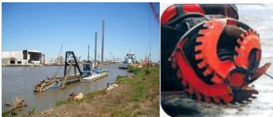
图 4.1-4 普通绞吸式挖泥船及普通绞刀头
