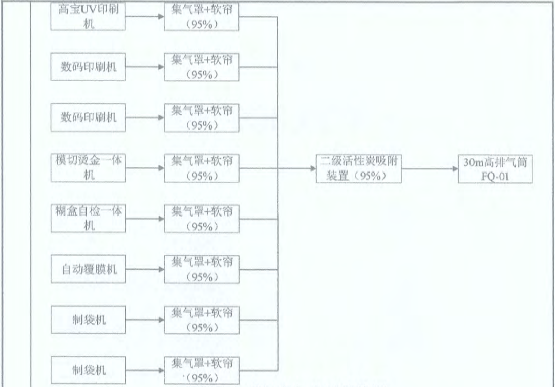
图 4-1 项目废气处理路线图
