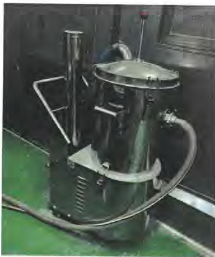
图 4-2 包装机设备自带袋式除尘器
