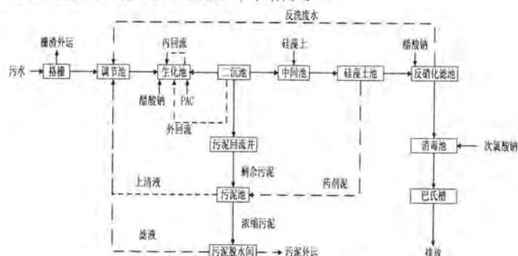
图 4-5 和凤镇污水处理厂处理工艺流程图
