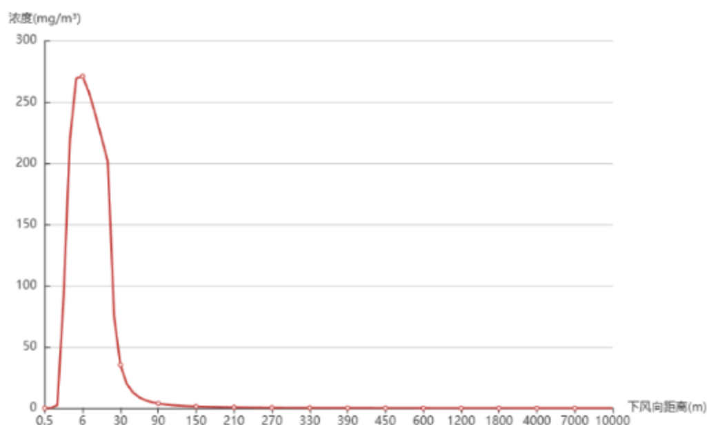
图 6.1-1 氢氟酸溶液包装桶破损氢氟酸泄漏下风向距离浓度曲线图 (最不利气象条件下)
