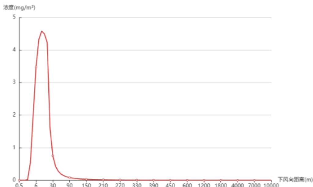
图 6.1-2 废酸罐破损硫酸泄漏下风向距离浓度曲线图（最不利气象条件下）
