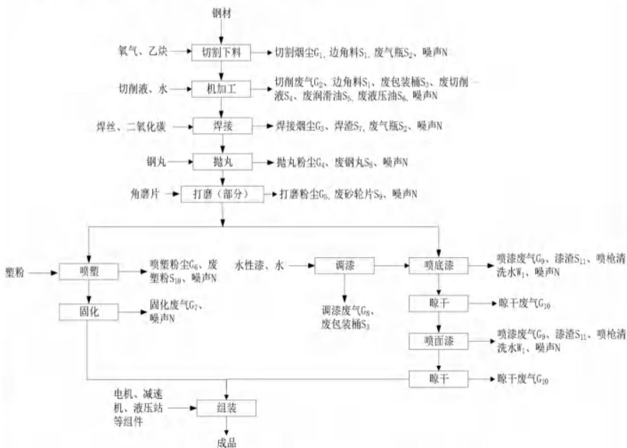
图 2-2 生产工艺流程及产污节点示意图
