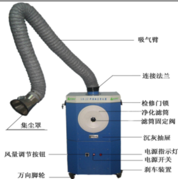
图 4-2 移动式除尘器结构简图
