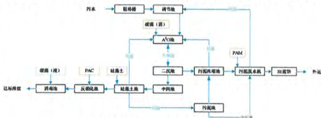
图 4-2 石湫污水处理厂处理工艺流程图
