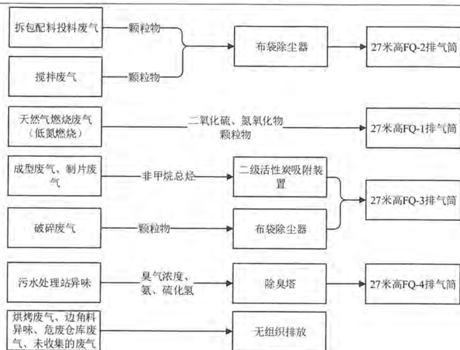
图 4-1 废气处理工艺流程图
